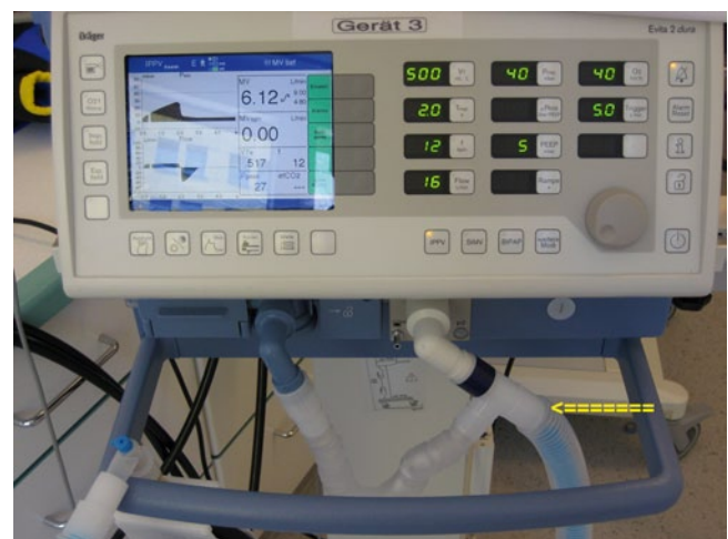
Abb. 1 ▶ Defektes „Schlauch-in-Schlauch“-Beatmungssystem mit Diskonnektion des blau gefärbten inneren Schlauchs (Pfeilspitze)
